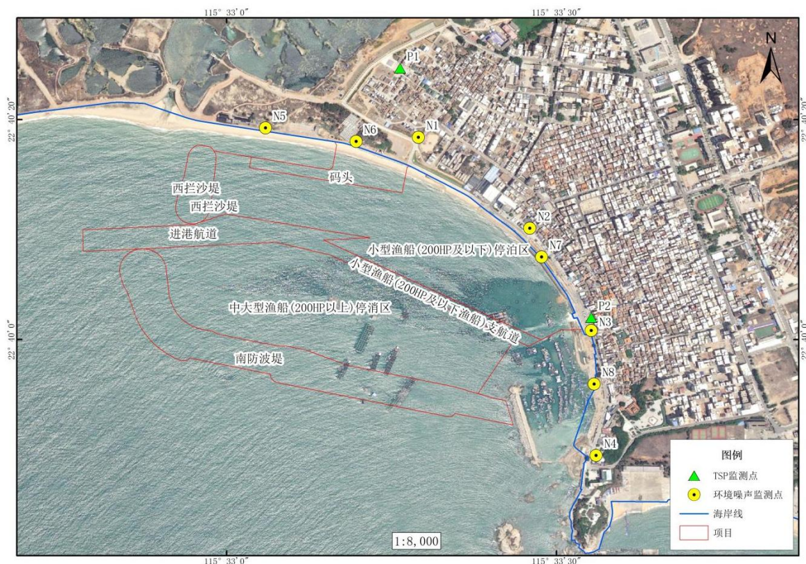
图 13.4.1-1 项目大气、噪声施工期监测站位图
