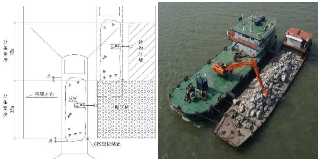
图 4.3.2-11 自航平板驳配反铲抛填平面示意图
