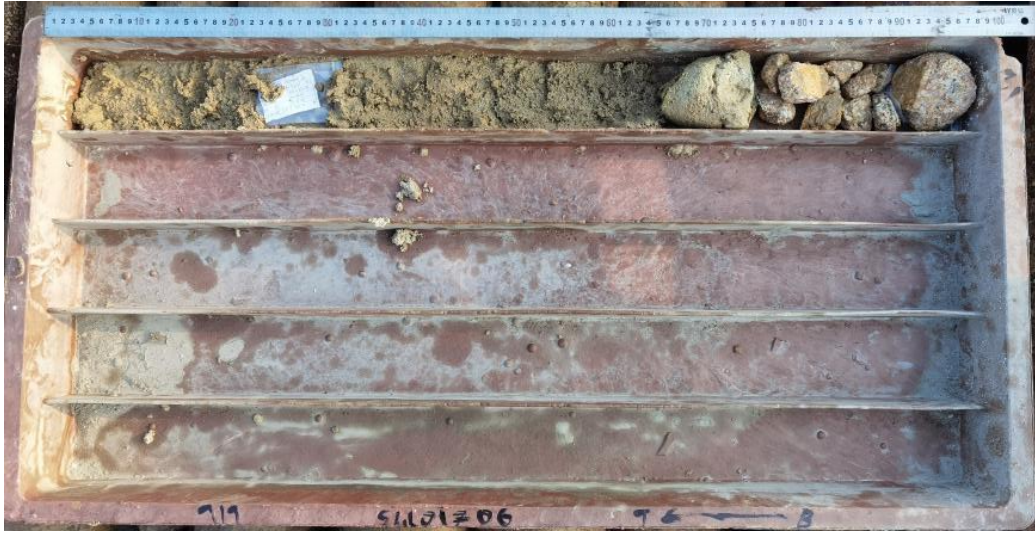
图 6.2.2-3 钻孔 SGL01Z06 揭露的第三层中砂、粗砂、砾质砂层及底部风化层和花岗岩 (进尺 20.0-31.0m)
