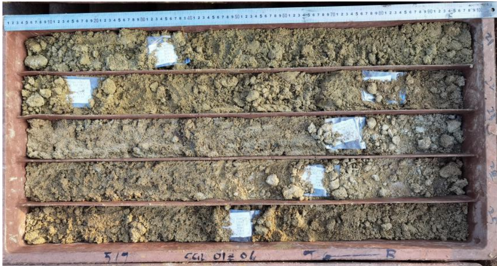
图 6.2.2-2 钻孔 SGL01Z06 揭露的第二层粉砂、细砂层及粘土层（进尺 5.0-20.0m）
