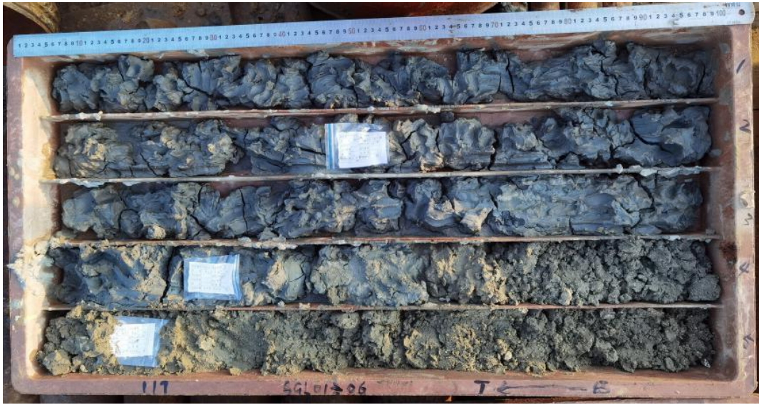
图 6.2.2-1 钻孔 SGL01Z06 揭露的第一层粉砂质淤泥层（进尺 0-5.0m）
