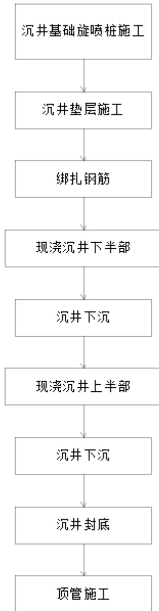
图 3.5.3-1 顶管段施工工艺流程图
