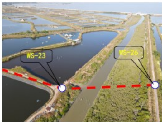
照片 3: 节点 WS-23~WS-25-1 段 (顶管施工)
